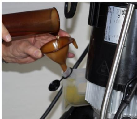
El depósito de la bomba de aceite lleva un visor de nivel de aceite y la función de llenado y vaciado integrado.
