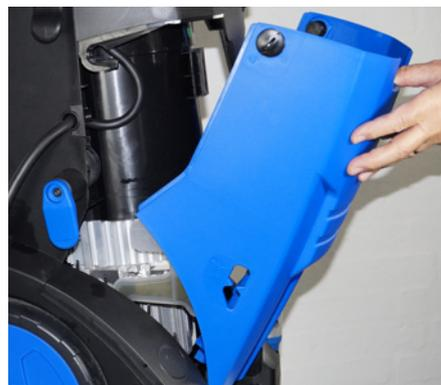
La carcasa se puede quitar de forma rápida para poder llegar a la bomba del motor.
