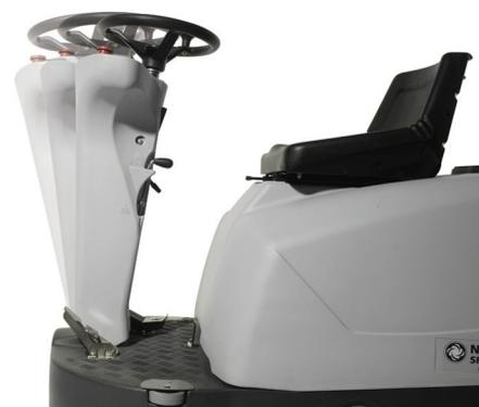
La columna de dirección es ajustable para que el acceso a la máquina sea fácil y para una máxima comodidad del usuario.
